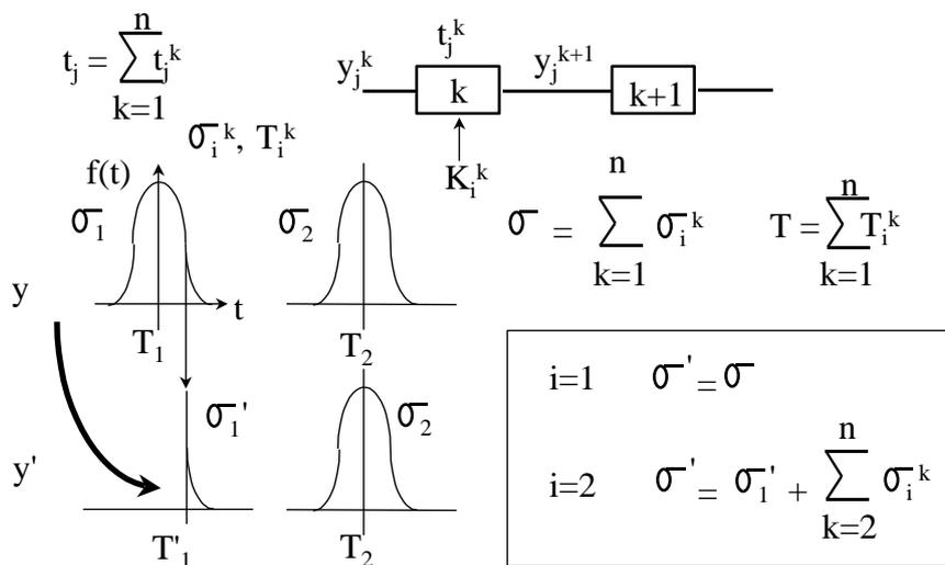
Attaque par *Ecart Type*. L'idée est d'utiliser une sous population de la sous clé (i) d'un étage de calcul (k) qui modifie l'écart type du temps de calcul du système
