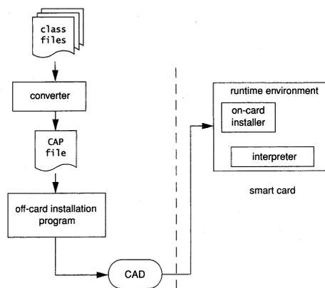
Un interpréteur Java (*interpreter*) logé dans la carte réalise l'exécution du *code byte* lors de l'activation d'un Applet.
