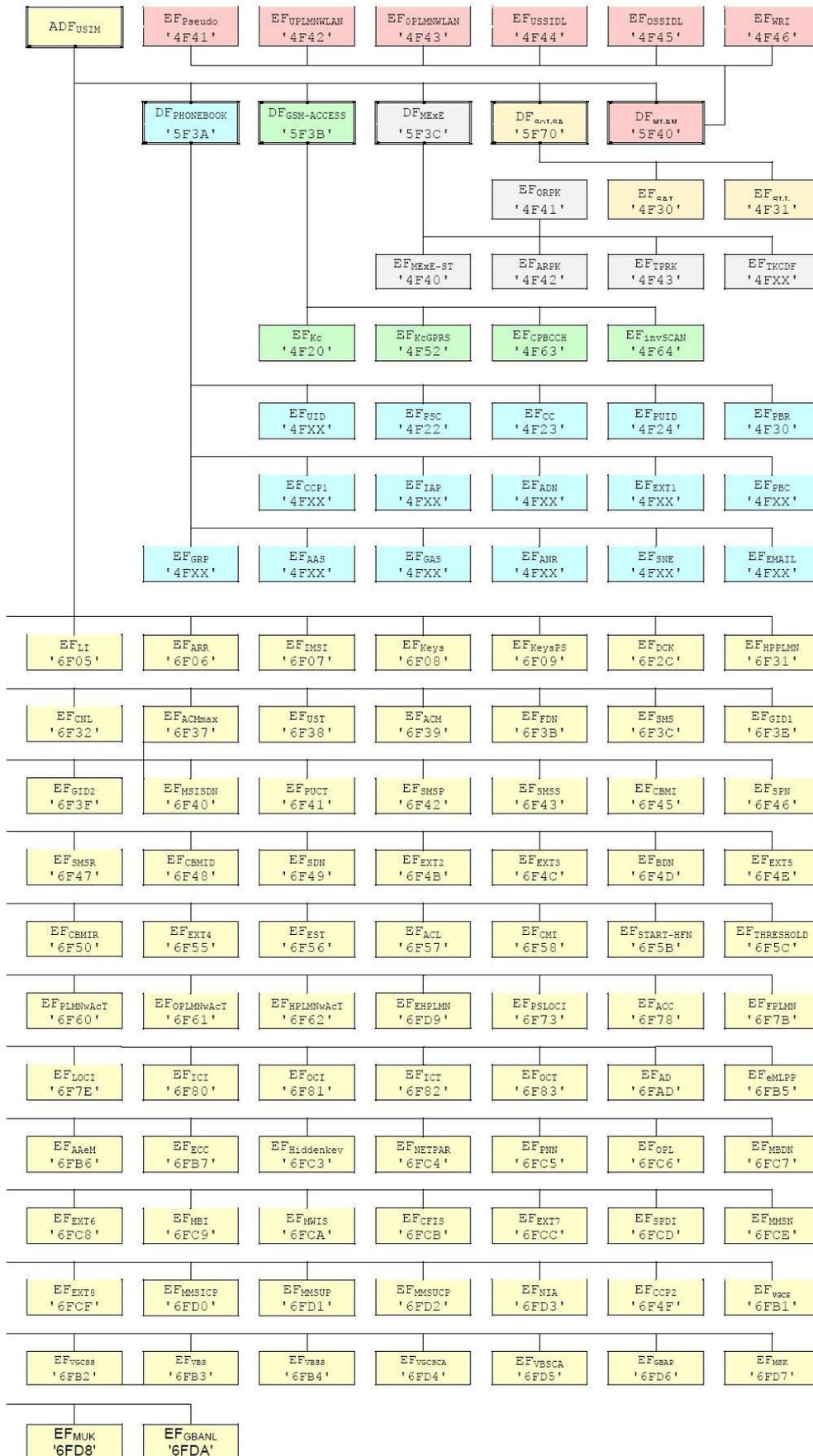
Figure 5. Le système de fichiers d'un module USIM
