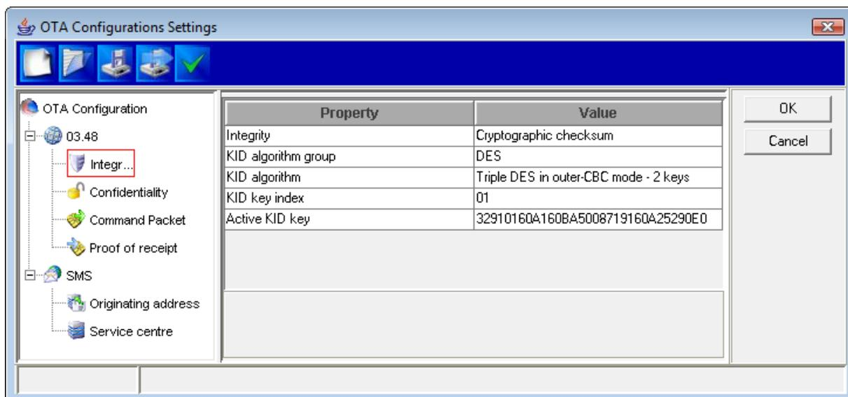
L'outil libre CAT LOADER, diffusé par le consortium SIM ALLIANCE est un loader basé sur la norme GSM 03.48. Il délivre des SMS pour le chargement d'applets et l'administration d'une carte SIM grâce au protocole Global Platform.
