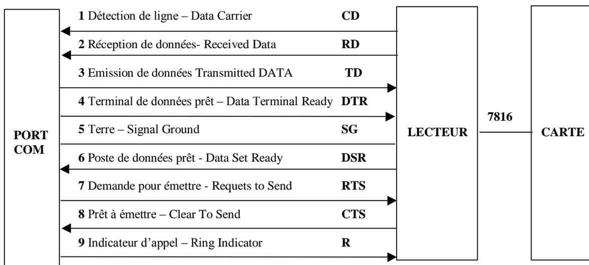
La fonction des lignes de communication est définie par le standard V24, dans lequel l'ordinateur est dénommé ETTD (Equipement Terminal de Traitement de Données dans la norme V24) et le modem ETCDD (Equipement Terminal de Circuit de Données).
