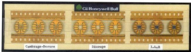
Le wafer (plaque de silicium circulaire qui comporte un ensemble de puces) est alors envoyé à l'**encarteur** qui réalise sa découpe, colle les puces sur des micromodules et en réalise le micro câblage. L'ensemble est alors protégé par une substance isolante. Il est ensuite collé sur un support en plastique (PVC) dans lequel on a préalablement usiné une cavité (le *bouton*).
