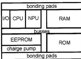
Les capacités mémoires sont comprises entre 128 et 256 Ko pour la ROM (surface relative 1), 64 et 128 ko pour l'E<sup>2</sup>PROM (surface relative 4), 4 et 8 Ko pour la RAM (surface relative 16). En raison de ces contraintes technologiques la taille de RAM est modeste; l'E<sup>2</sup>PROM occupe une portion importante du CHIP. Les écritures en E<sup>2</sup>PROM sont relativement lentes (de l'ordre de 1 ms par mot mémoire de 32 à 64 octets), et le nombre de ces opérations est
