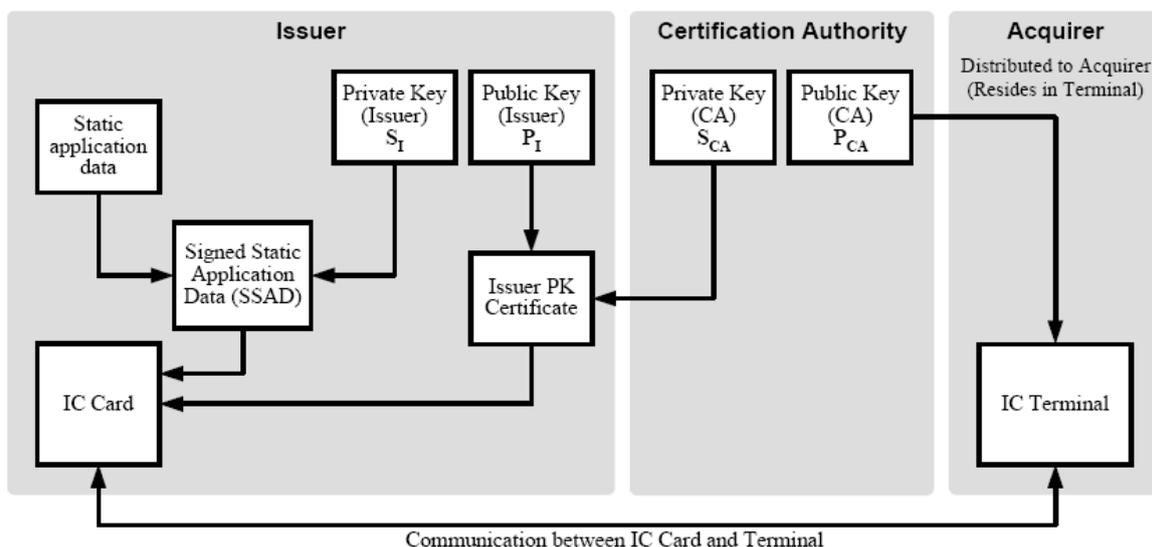
L'authentification statique (SDA) est une signature réalisée à l'aide de la clé privée de l'émetteur, elle est pointée par le tag '93' *Signed Static Application Data*. Elle résulte du chiffrement d'une suite de TAGs, identifiée par la structure AFL ou par un tag optionnel, le *Static Data Authentication List* ('9F4A').
