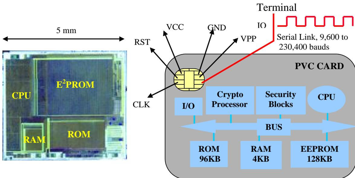
Les classiques processeurs 8 bits ont des puissances de traitements comprises entre 1 et 3 MIPS, ce paramètre est supérieur à 33 MIPS pour les nouvelles architectures à bases de processeurs RISC 32 bits.
